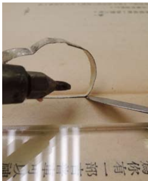
使用熱風筆移除雙面膠帶。
