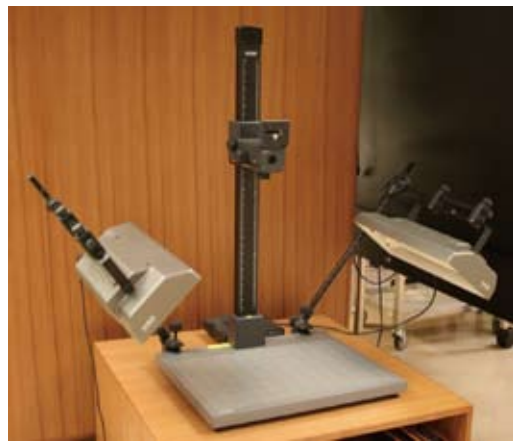
德國KAISER標準色溫太陽燈翻拍台組，符合標準色溫5000K（冷光源燈管），適合長時間作業。
