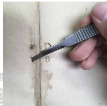
圖 8 以手術刀剝除鏽蝕的紙張纖維，避免日後鏽蝕擴大
